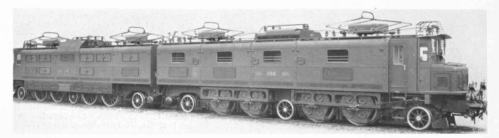
Abb. 25. Ae \*/14 Einheitslokomotive für Schnell- und Güterzüge der S. L. M. mit BBC, 1932. — Länge 34,0 m, Dienstgewicht 245 t, Reibgewicht 157 (168 t), Vmax 100 km/h. Belastungsnorm auf 26% to für Schnellzüge 600 t bei 62 km/h, für Güterzüge 750 t bei 50 km/h. Stundenleistung 7500 PS bei 65 km/h (Beschreibung \*S. B. Z.\* 19. März 1932).
