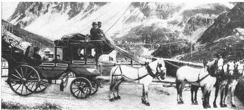
Abb. 18. Die Schweizer Alpenpost beförderte auf 10‰ mit „5 PS“ acht Reisende mit 9 km/h. Vor 1830 (Vollendung der Gotthardstrasse) förderte bis 30‰ das Saumtier \frac{1}{10} t Last mit 4 km/h.
