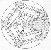
Abb. 22. Vertikal- und Horizontalschnitt durch die Laufradnabe. — 1:50
