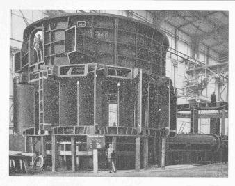
Abb. 19. Feste Leitschaufeln mit aufgebautem Schachtring.
