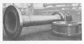
Abb. 23. Hohle Turbinenwelle; rechts Laufrad-Servomotorzylinder.
