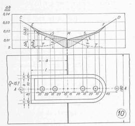
Abb. 14 und 15. Relative Verschiebungen bezw. Schubspannungen in Flankennähten, wobei die Stirnnähte mitwirken; bei einem Vollwandstab.
