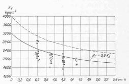
Abb. 23. Bruchfestigkeit der Flankennähte bei doppelseitiger Anordnung der Laschen. o Versuche 1923, l=20 mm, o l=30 mm, o l=40 mm,  $\times$  Versuche 1924.
