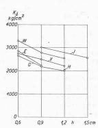
Abb. 19. Mittlere Abreissfestigkeit Κδ der Stirnnähte in Abhängigkeit von der Nahthöhe.
