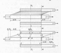
Abb. 2. Schema der Beanspruchung der Flankennähte bei Stäben mit Trennfuge, oben nur durch innere, unten durch innere und äussere relative Verschiebungen.
