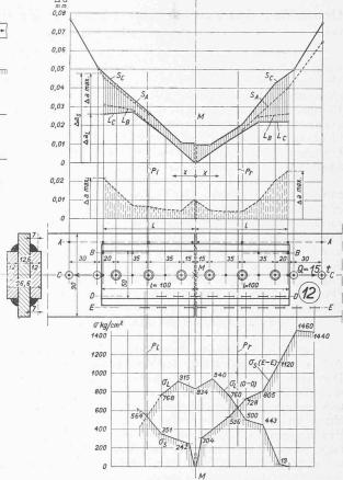
Abb, 5. Experimentelle Feststellung der relativen Verschiebungen bezw. der Schubspannungen der Flankennähte bei einem Stab mit Trennfuge.
