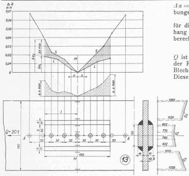
Abb. 6. Experimentelle Feststellung der relativen Verschiebungen bezw. der Schubspannungen der Flankennähte bei einem vollwandigen Stab.
