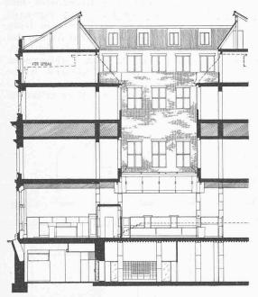
Abb. 10. Querschnitt nach dem Umbau. — 1:300.
