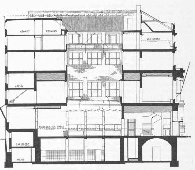
Abb. 9. Längsschnitt durch Schalterhalle und Bank-Eingang. — 1:300.
