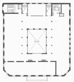
Abb. 8. Grundriss der neuen Obergeschosse. -1:400.
