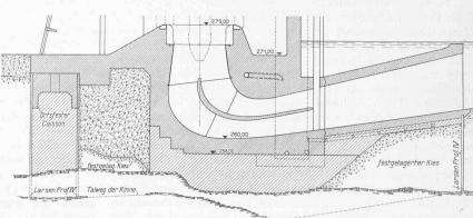
Abb. 13. Querschnitt durch das Maschinenhaus: oben normal, unten in der Erosionsrinne. - 1:500.
