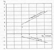
Abb. 14. Prozentuale Aenderung der Wassermenge bei konstanter Ueberfallhöhe und
