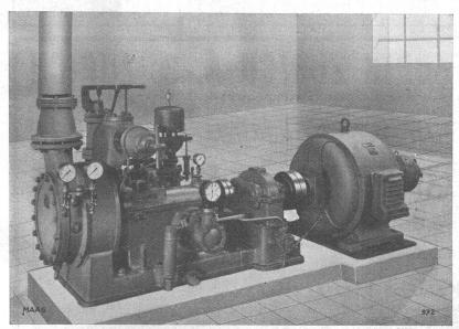
Maag-Turbogetriebe Type 6 16s 100 PS, Drehzahlen n = 6000/1500, für Dampfturbinenanlage in einer schweiz. Bierbrauerei.
