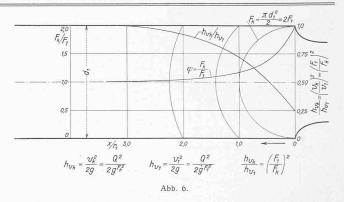
Die Abweichungen der gemessenen Durchfluss-Koeffizienten von den berechneten Kurven erklären sich daraus, dass die Druckabnahmestellen auf der Einlaufseite sich nicht genau an den für die Berechnung vorausgesetzten Stellen befinden und dass die verschiedenen Düsen auf verschiedene Arten geeicht wurden. Teils wurden die Düsen durch Behältermessung, teils durch Ueberfallmessung, teils durch Salzmessung und teils nach dem Verfasser unbekannten Messmethoden geeicht.
