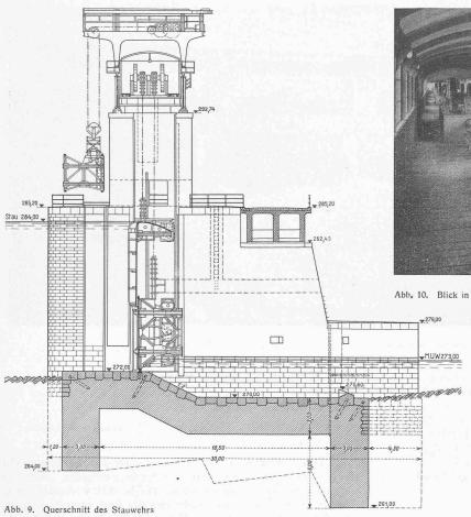
Abb. 9. Querschnitt des Stauwehrs darunter Grundrisse und Horizontalschnitte.
