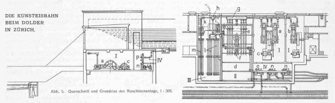
LEGENDE: 1 Kompressorenräume, II Verdampfer- und Akkumulatoren-Raum, III Kondensatoren-Raum, IV Solepumpen-Raum. — a Zwillingskompressor, b Kompressor für Erweiterung, c Antriebmotor, d Solekasten, e Verdampfer, f Rührwerke, g Flüssigkeitsabscheider, h Oelabscheider, i Kühlwasserpumpe, k Spritzwasserpumpe, l Gegenstrom-Kondensatoren, m desgl. Erweiterung, n o Solepumpen, p Umschalter.
