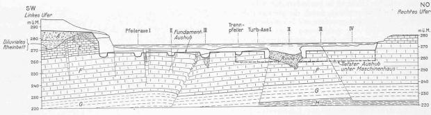
Abb. 4. Geologisches Profil durch das Rheinbett in der Bauaxe des Kraftwerks Ryburg-Schwörstadt. — Masstab 1:2000.
