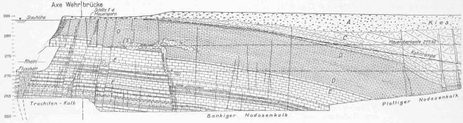
Abb. 5. Geologisches Profil längs des linken Ufers des Rheins vom Wehr bis rd. 100 m unterhalb. — Masstab 1:600.
