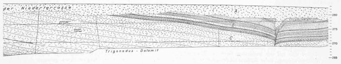
Legende zu den Abb. 4, 5 und 5a. A Kies der Niederterrasse, B Letten-Kohle, C Trigonodus-Dolomit, D Plattiger Nodosenkalk, E Bankiger Nodosenkalk mit Dolomitlagen, F Trochiten-Kalk, G Helle Dolomiten, H Dunkle Tone mit Gips und Anhydrit.
