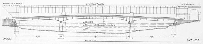
Abb. 2. Die im Bau begriffene Strassenbrücke über den Rhein bei Koblenz-Waldshut (dahinter die Eisenbahn-Fachwerkbrücke). — 1:800.
