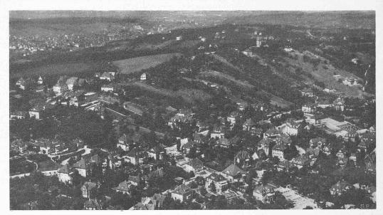
Abb. 16. Serpentinenstrasse an der Lenzhalde in Stuttgart. Die Serpentine (steigt nach rechts ausholend und wieder nach links wendend) ist zu flach angelegt, lädt übermässig aus und ist beidseitig bebaut; die Folge ist eine ungeordnete Massierung der Bebauung. (Luftfoto Strähle, Schorndorf.)
