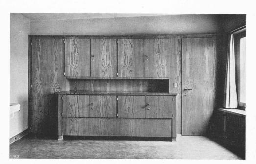
Abb. 23. EINGEBAUTE SCHRÄNKE IM ATELIER, ESCHE HELL; RECHTS TÜR ZUR GARAGE BODEN GRAUGRÜN LINOLEUM, DECKE WEISS
