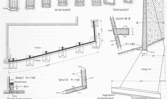
Abb. 31. Terrassenmauer in Eisenbeton, Horizontalschnitt und Ansicht 1:300. - Details 1:60.
