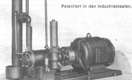
Zweistufiger, einzylindriger Rotationskompressor für 6 bis 8 at Druck.
