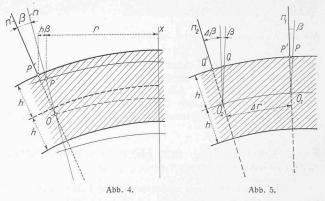
änderung die Flächennormale  $n_1$  des Punktes P um  $\beta$  und die Flächennormale  $n_2$  des Punktes Q um  $(\beta + \Delta \beta)$ . Setzen wir voraus, dass die Mittelfläche, die die Punkte  $O_1$  und  $O_2$  enthält, bei der Verbiegung keine Verzerrung erleidet, so ändert sich die ursprüngliche Länge  $\Delta r$  um  $h \Delta \beta$ . Die Dehnung in Richtung des Meridians ist
