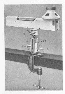
Abb. 7. Stehklinometer mit seiner Befestigungs-Einrichtung für Eisenträger.
