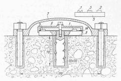
Abb. 8 und 9. Messtelle für Setzklinometer. Querschnitt. — Masstab 1:4.
