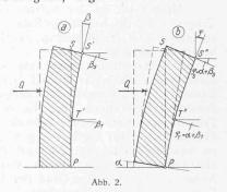
einzelnen Anteile aus den gewonnenen Messergebnissen herauszuschälen. Wir wollen an einem Beispiel diese Gedanken näher verfolgen. Abb. 2 zeigt den Querschnitt durch eine Mauer, auf die die Kraft Q wirkt, die etwa die Resultierende des auf der Mauerfläche lastenden Wasserdruckes darstellen möge. Infolge der Belastung verformt sich der Mauerquerschnitt. Die in S' beim Belastungszustand Q gemessene Drehung sei  $\beta_s$ . Da im unbelasteten
