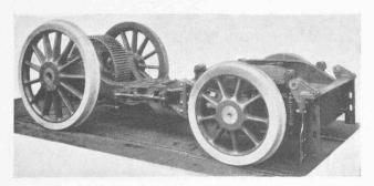
Abb. 4. Kombiniertes Drehgestell der Lokomotive Nr. 11851.
