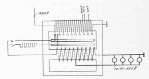
Abb. 8. Prinzipielles Schaltschema der Hochspannungssteuerung.
