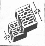
Steinbreite gleich der Mauerstärke
