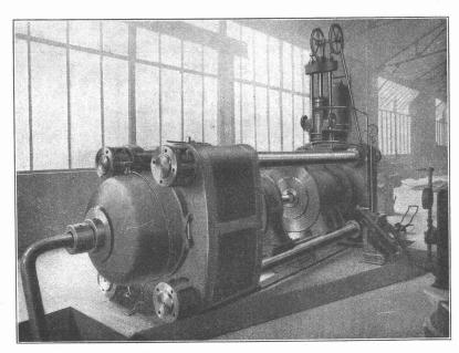
Hydraulische Metallstoss-Presse für 1200 Tonnen.
