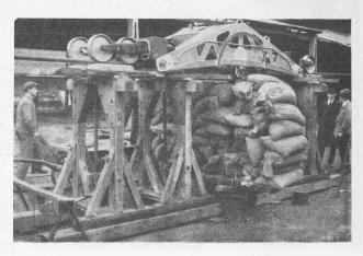
Abb. 4. Belastung mit 3200 kg des Hauptrahmengebildes des 16-rädrigen Laufwerks eines Fahrzeuges in der Werft Luzern.
