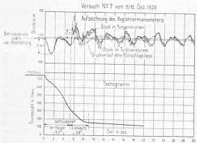
Abb. 13. Abschaltversuch an Pumpe 4. Normale Abschaltung mit Rückschlagventil im Ablieferungszustand (versehen mit Luftkatarakt). Betriebzustand vor der Abschaltung: Ventilöffnung 117 mm, Wassermenge 1118 I/sec, Förderhöhe 262,8 m, Leistung der Pumpe 5040 PS, Leistung des Motors 3875 kW, Drehzahl 750 Uml/min.
