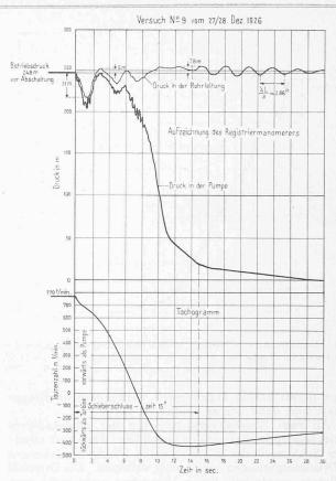
Abb. 16. Abschaltversuch an Pumpe 4. Rückschlagventil ausgeschaltet. (Abschluss durch Keilschieber.) Schieberschlusszeit 15 sec. Betriebszustand vor der Abschaltung: Wassermenge 1365 I/sec, Förderhöhe 256 m, Leistung der Pumpe 6075 PS, des Motors 4650 kW, Drehzahl 770 Uml/min.
