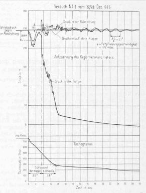
Abb. 14. Abschaltversuch an Pumpe 4. Normale Abschaltung mit Rückschlagventil im Anlieferungszustand (versehen mit Luftkatarakt). Betriebzustand vor der Abschaltung: Ventilöffnung 100 mm Wassermenge 1320 l/sec, Förderhöhe 260,4 m, Leistung der Pumpe 5945 PS, Leistung des Motors 4550 kW, Diehzahl 750 Uml/min.
