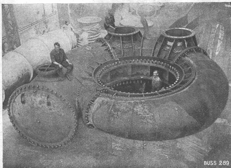
Solralgehäuse einer Turbine, Durchmesser des Einlaufes 1900 mm, sich reduzierend auf ca. 1000 mm, Betriebsdruck 8 Atm., Prüfdruck 14 Atm.
