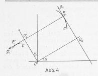
Umgekehrt kann aus der Kurve C die Stützfunktion p(u) wieder entnommen werden, indem man den Abstand vom Anfangspunkt O für jene Tangente konstruiert, die mit der y-Axe den Winkel u einschliesst.
