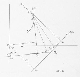
Dem Prozess des Integrierens entspricht das Zeichnen der Evolvente des Linienbildes.
