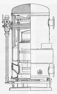
Abb. 10 und 11. Kupferner Gasheizkessel von Junkers & Cie., Dessau.
