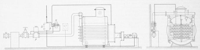
Abb. 5. Generelles Schema der Regulier- und Sicherheitsvorrichtungen des ROM-Gaskessels.
