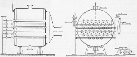
Abb. 7. Längsschnitt und Vorderansicht des Hochdruck-Gaskessels der Gebr. Körting in Körtingsdorf.
