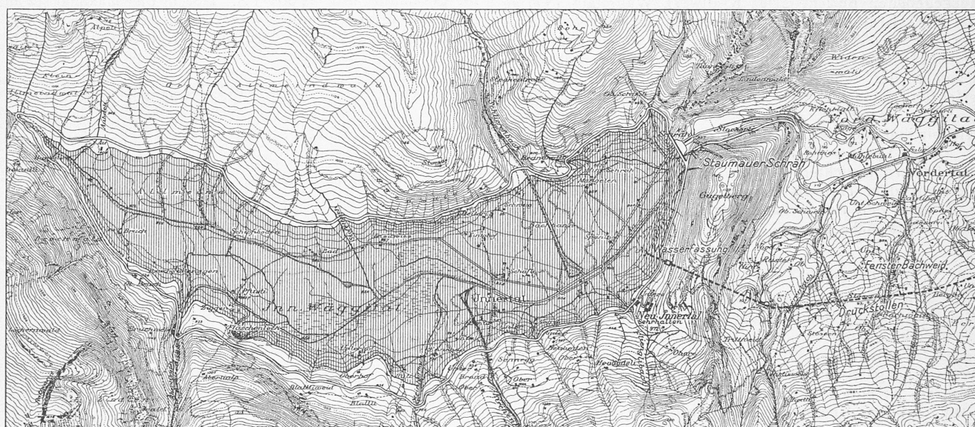
Abb. 2. Stausee im Innertal mit Staumauer, Wasserfassung und Druckstollen I. — Masstab 1 : 35000 (10 m-Kurven).
