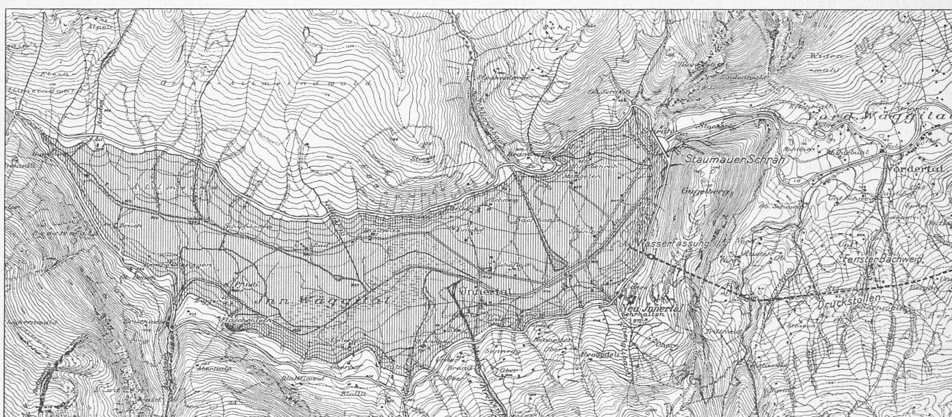
Abb. 2. Stauee im Innertal mit Staumauer, Wasserfassung und Druckstollen I. — Masstab 1 : 35000 (10 m-Kurven).
