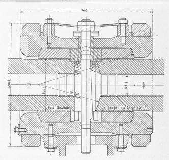
Abb. 7. Kolbenstangen-Kuppelung einer Grossgasmaschine. — 1:10.
