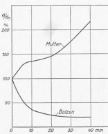
Abb. 9. Verhältnis der Biegungsspannungen im ersten Gang in Abhängigkeit der Hinterdrehungstiefe.
