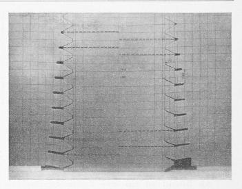
Abb. 6. Belastetes Modell des hinterstochenen Gewindes.
