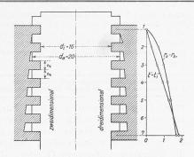
Abb. 3. Profilierung des Solt-Gewindes.
