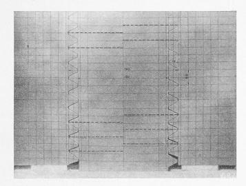
Abb. 5. Belastetes Gummimodell des nicht hinterstochenen Gewindes.
