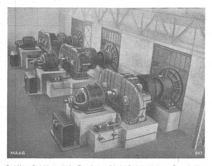
Drei Maag-Reduktionsgetriebe, Type G 110 — Z II, für Zentralantrieb von Zementmühlen, mit nachgiebiger patentierter Maag-Kupplung zwischen Getriebe und Mühle. Leistung: 625 PS, Drehzahlen: 960/19 Touren/min. Aufstellungsort: Casablanca.
