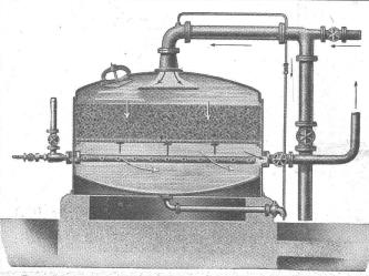
Geschlossene Schnellfilteranlage System Reisert
