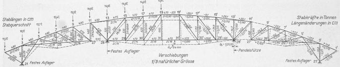
Abb. 2. Schema des Lehrgerüstes, System Klinke & Meyer, mit Eintragung der rechnungsmässigen Spannungen und Verformung (verzerrt) durch die volle Betonlast.
