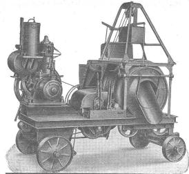
ist die vom Kleinmeister und Grossbauunternehmer bevorzugte Schweizer Qualitäts-Betonmischmaschine. Sie verbindet letzte Vervollkommnung mit höchster Leistungsfähigkeit. Gedrängte und übersichtliche Bauart. Rasche und vollkommene Mischung von Fein- und Grobgut. Mit Bauwinde ausgerüstet, ersetzt der Raco-von-Roll-Mischer eine besondere Aufzugsinstallation. - Grössen von 4 bis 60 m3 Stundenleistung.
