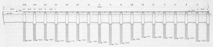
Abb. 6. Längsschnitt der Quaiverbreiterung mit den 22 auf je 17 Eisenbeton-Pfählen ruhenden Pfeilern. — Masstab 1:1000.
