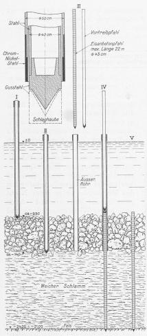
Abb. 7 Bauvorgang zur Rammung der Eisenbeton-Pfähle. — Masstab 1: 300, Detail 1: 30.
