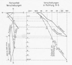
Abb. 8 und 9. Diagramm der trigonometrischen Bewegungs-Beobachtungen.
