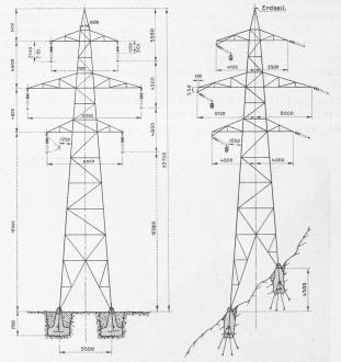
Abb. 10. Normaler Tragmast (links) und Winkelmast. — Masstab 1:400.
