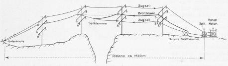
Abb. 12. Schematische Darstellung des Seilzugs mit Motorwinde,
