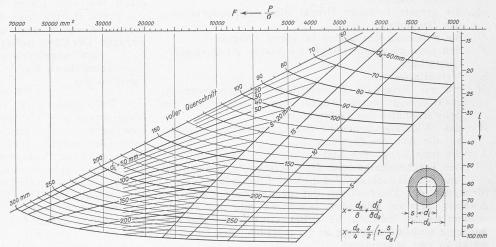
Abb. 5. Grundblatt für kreisförmige, hohle und volle Querschnitte.
