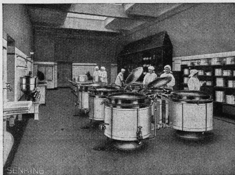
Senking-Ideal-Kochkessel und Kipptöpfe aus nichtrostendem Stahl V2a. Innenkessel mit dem oberen Profilring nahtlos aus einem Stück hergestellt. Vollkommen hygienisch
