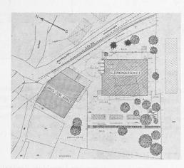
Projekt Nr. 7, "Südwestfront". In einem annähernd quadratisch freigestellten Baublock sind die verlangten Räume untergebracht. Die einzelnen Geschosse mit besondern Zugängen weisen gute Verhältnisse auf. Die beiden Säle im I. Stock sollten mit Rücksicht auf den Gebrauch ausgewechselt werden. Der Nachteil der allzugrossen Raumtiefen der Schullokale ist wie bei Nr. 4 auch hier festzustellen. Die Aufschliessung des Vorgeländes ist für die
