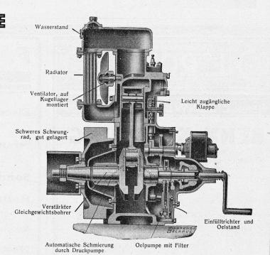
Die VENDEUVRE-SCHWEROL-MOTOREN aus den Werken in DIEPPE **ermöglichen** HOCHSTE WIRTSCHAFTLICH-KEIT, sowohl hinsichtlich der QUALITÄT wie der MENGE DES BRENNSTOFFES, der verwendet werden kann
