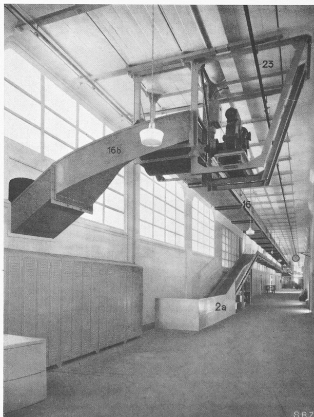
Abb. 27. Förderbänder und Hängebahn im Gang des Erdgeschosses.
