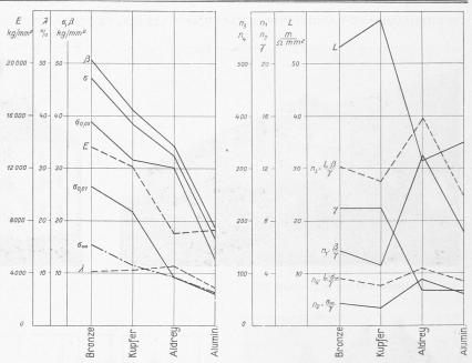
Abb. 1. Bruchfestigkeit β, Streckgrenze σ, Elastizitätsgrenzen für Dehnungen 0,05 u. 0,01, Dehnung λ. Abb. 2. Elektrische Leitfähigkeit L, spezifisches Gewicht λ, Verhältniszahlen n1, n2, n3 und n4.
