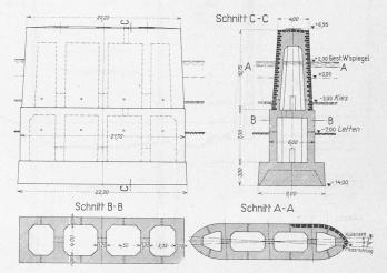
Strompfeiler zum Entwurf Nr. 18 (Locher & Cie.). — 1:100.
