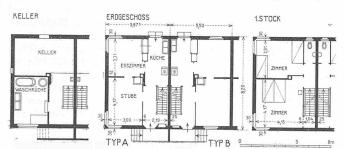
Abb. 2. Grundrisse von Typ A und B. - Masstab 1:300.
