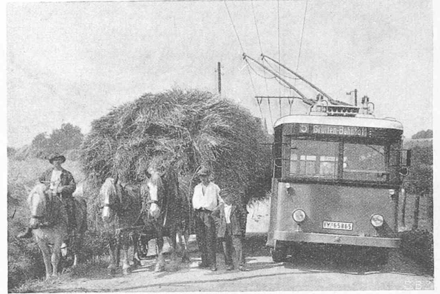
Abb. 1 und 2. Dreiachsiger elektrischer Omnibus mit Oberleitung für den Lokalverkehr Mettmann-Gruitens im Rheinland.
