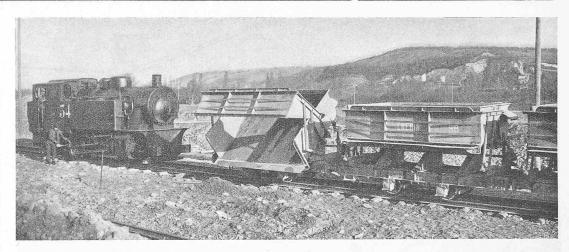
Abb. 14. Eiserne Förderwagen für 6 m3 und Lokomotive von 33 t.
