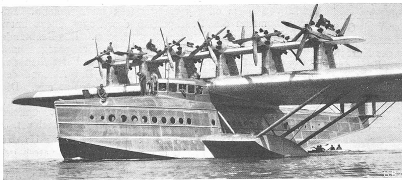
Abb. 12. Dornier Wasserflugzeug Do X, Länge 40 m, Spannweite 48 m, Nutzladung 22 t, 6000 PS.
