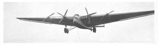
Abb. 15. Junkers Landflugzeug G 38, Länge 23 m, Spannweite 44 m, Nutzladung 11 t, gesamte Motorenleistung 2400 PS.
