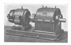
Schneckengetriebe im Oel laufend.
