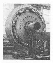
Abb. 2. Hydraulisch-mechanische Kupplung, Bauart Voith-Föttinger.
