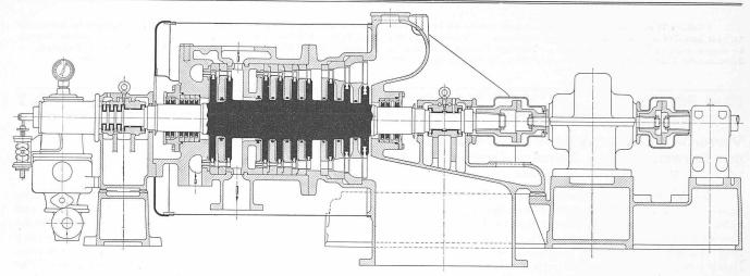
Abb. 4. Längsschnitt durch die Anzapf-Dampfturbine von 460 kW, 3000 Uml/min, geliefert von der Maschinenfabrik Oerlikon. — Masstab 1:20.
