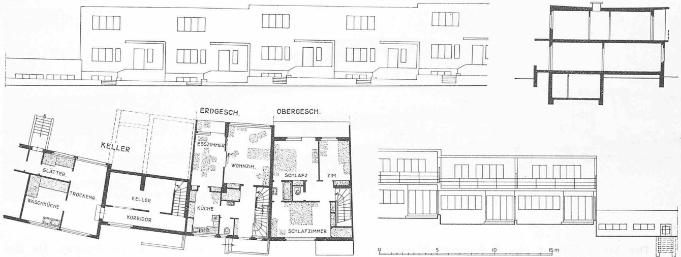
Abb. 4. Typ AII, Einfamilien-Reihenhaus mit fünf Zimmern, Wohnraum 5,00 \times 3,95 m. — Oben Ostfassade und Schnitt, darunter Grundrisse und Westfassade, 1 : 300.
