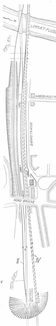
Abb. 3. I. Etappe zwischen Langstrasse und Hardstrasse. — 1 : 5000. — A, A', A'', C, P, R, T Abstellgruppen für Personenzüge. B und D Rangiergruppen für Güterzüge.
